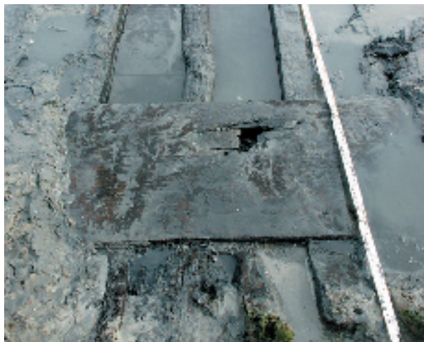
Abb. 6: Auf der Backbordseite freigelegte, auf die Bodenplanke aufgenagelte Wegerungsplanke. Blick von Backbord.
