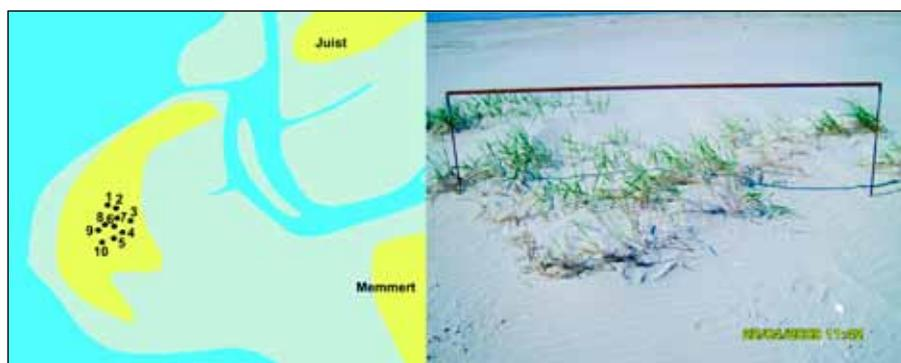
Abb. 12A: Lage der eingesetzten „sediment erosion bars“ im Dünenfeld; 12B: SEB an Station 1. Foto: Liebezeit
