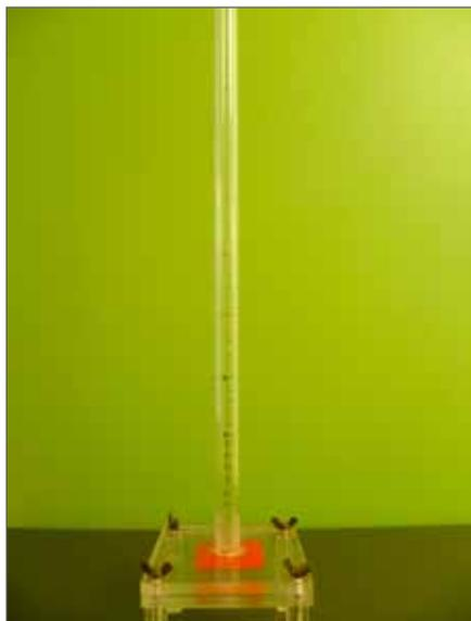
Abb. 2: Messung des Durchdringungsdruckes (Hydratic-Head-Test).
