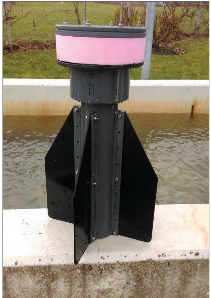
Abb. 4: Driftboje „Eddy“ der zweiten Generation.
