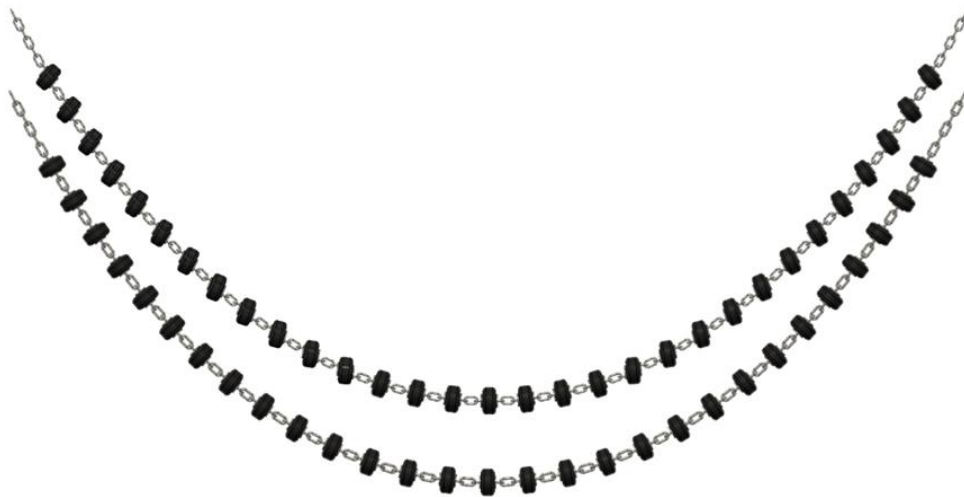
Abbildung 49. Vergleich einer konventionellen Roller- und einer Roller- mit achsversetzten Rollen (oben). Gezeigt ist ein Beispiel einer achsversetzten Rolle, bei der der mögliche Anstellwinkel begrenzt ist (Abbildung 50 links). Deshalb sind alle Rollen gerader als bei dem herkömmlichen Grundgeschirr, aber nicht immer optimal. Mit der Verwendung anderer Rollentypen (siehe z.B. Abbildung 50 mitte und rechts) lässt sich das beheben. Grafik: Thünen/Uwe Lichtenstein
