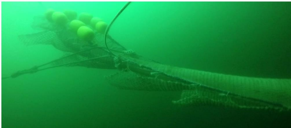
Abbildung 17: leerer Steert mit EVA-Floats mit 40 kgf Gesamt-Auftrieb an den Laschen, sowie einem Hund (Steertboje) aus 2 m Leine und 2 Stck. 28 mm Kugeln mit jeweils 8,2 kgf Auftrieb
