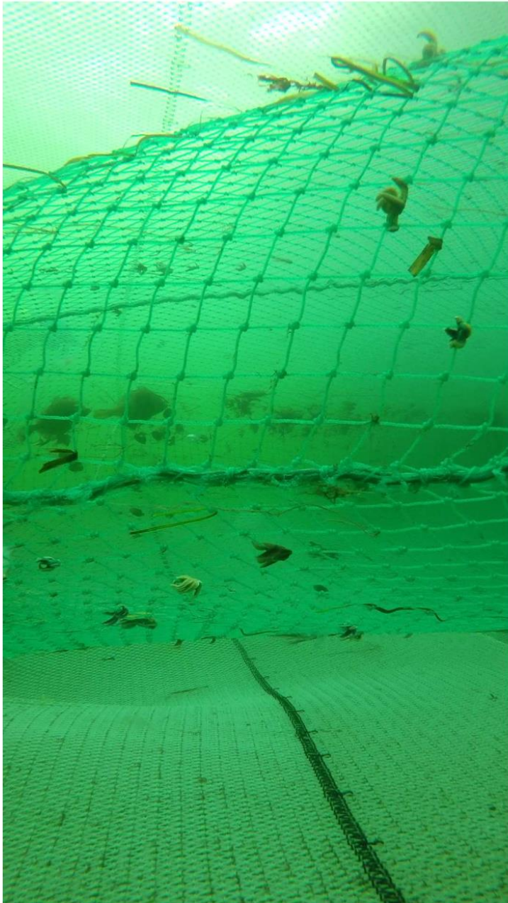
Abbildung 30: Seitlicher Blick auf ein Stück Siebnetz im Schleppnetz Figure 30: Lateral view of a piece of sieve net in the trawl net
