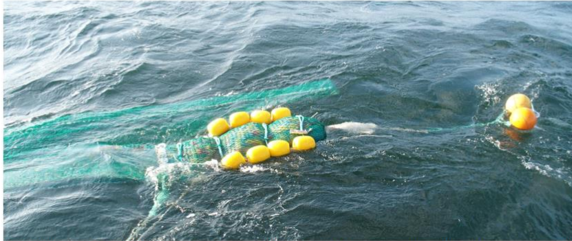
Abbildung 16: Mit 0,5 m 3 Fangimitat gefüllter Steert mit 4 Ringverstärkungen um den Hievsteert, hinter dem Hievstropp EVA-Floats mit 40 kgf Gesamt-Auftrieb an den Laschen, sowie einem Hund (Steertboje) aus 2 m Leine und 2 Stck. 28 mm Kugeln mit jeweils 8,2 kgf Auftrieb
