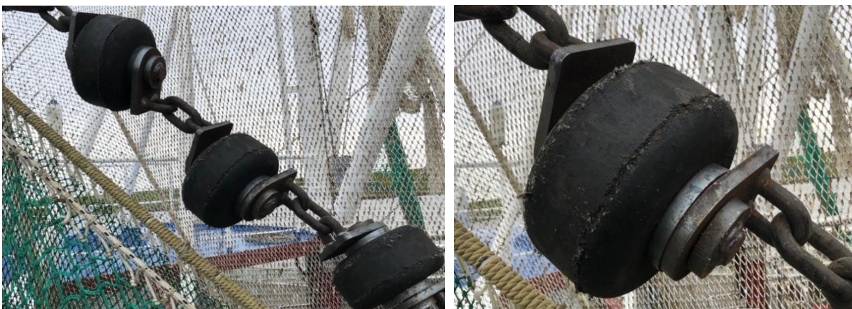
Abbildung 52. Achsversetzte Rollen auf dem Krabbenkutter 'Hindenburg' (Stefan Schneidereit). Es ist deutlich zu erkennen, dass die Rollen sich nicht selbstständig ausrichten. Grund hierfür sind wahrscheinlich die seitlichen Kräfte auf den beweglichen Wangen.
