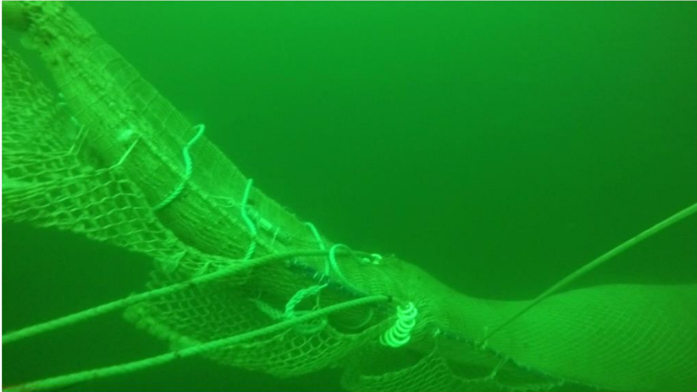
Abbildung 18: leerer Steert nur mit einer Steertboje aus 2 m Leine und 2 Stck. 28 cm Kugeln mit jeweils 8,2 kgf Auftrieb Figure 18: Empty codend with only one codend buoy made of 2 m line and 2 pcs. 28 cm balls with 8.2 kgf buoyancy each.
