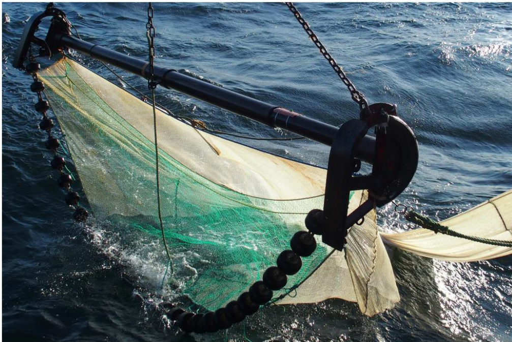
Abbildung 7: Die obere Spannleine ist nur an den Kurrschuhen befestigt, die untere hier überflüssige Spannleine ist lose und zieht die Siebmatte horizontal zusammen. Figure 7: The upper tensioning line is only attached to the beam shoes, the lower tensioning line, which is superfluous here, is loose and pulls the sieve mat together horizontally.
