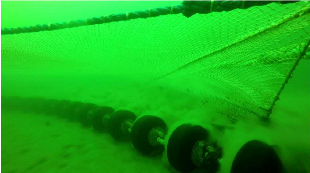
Abbildung 39: Blick auf den Seitenkeil einer traditionell abfallend geschnittenen Garnelenbaumkurre
