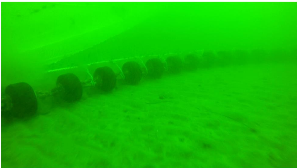
Abbildung 20: Der Blick in das Schleppnetz beim Fieren kurz vor dem Aufsetzen der Rollenkette zeigt gleichmäßig ausgereckte Netzbereiche
