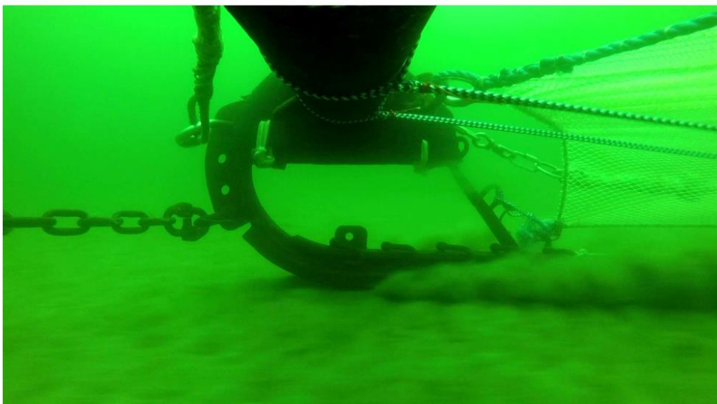
Abbildung 37: Blick auf das Seitenblatt der Kurre mit geradem Rollentau und die Sandwolke des Kurrshuhes Figure 37: View of the side panel of the beam trawl with straight roller rope and the sand cloud of the beam shoe
