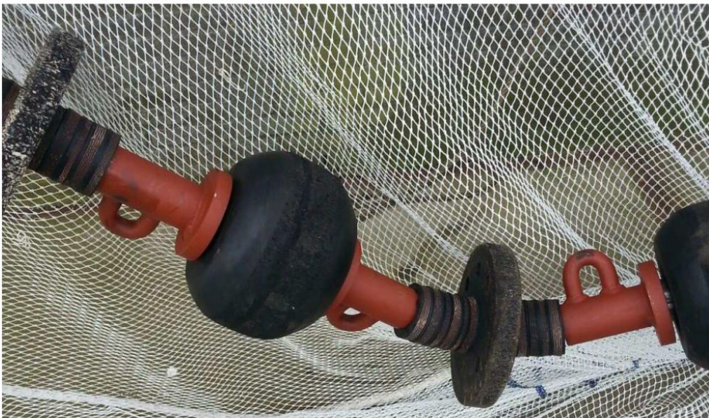
Abbildung 35: Rollentau einer Pulskurve Figure 35: Roller rope of a puls beam trawl
