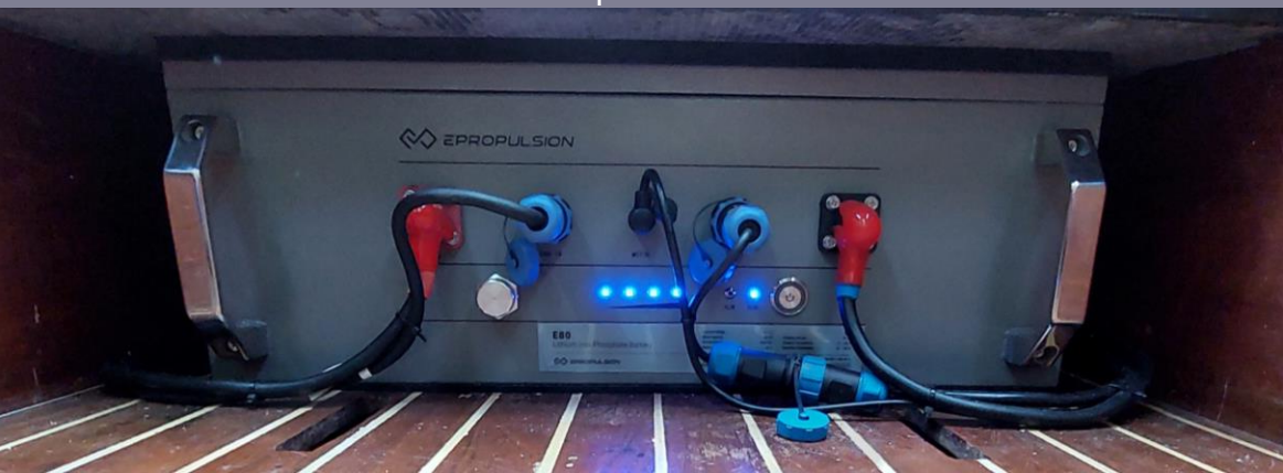
48-V-LiFePO 4 - Akku mit 4 kWh
