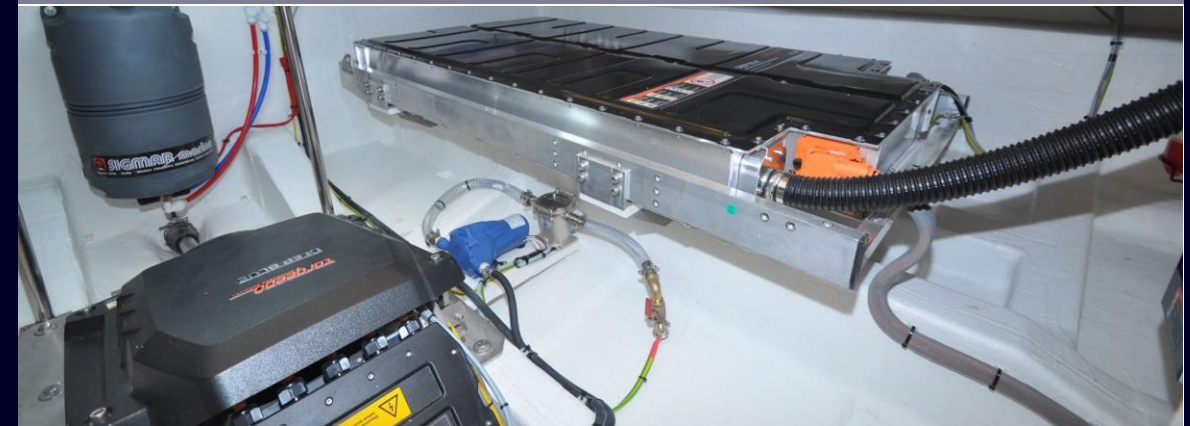
50kW Deep Blue Antrieb mit 40 kWh BMW i3 Akku
